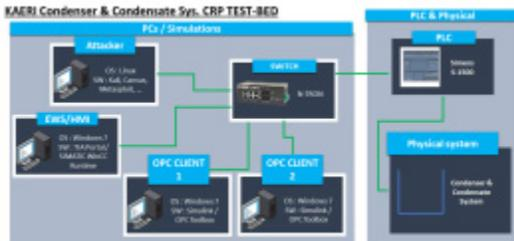
[그림 7] 복수기 및 복수계통 Testbed 구성도
